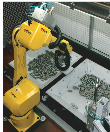
Malý robot při vybírání výkovek ze zásobníku
