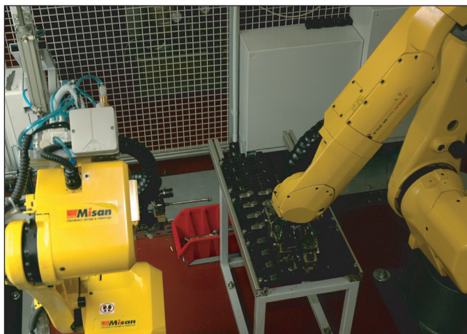
Spolupráce robotů při přebírání polotovarů z matrice
