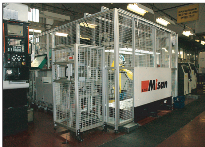
Pohled na robotickou buňku, v popředí vstup pro součásti vyrobené na jiném stroji
