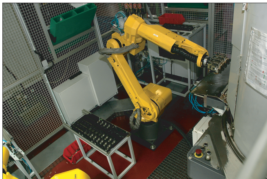
Uspořádání robotického pracoviště. Větší robot právě obsluhuje obráběcí centrum, v pozadí za ramenem robotu se nachází pracoviště srážení hran a pracoviště měření závitů. Uprostřed mezi roboty je předávací matrice, těsně téměř v zákrytu za menším robotem je patrná jednotka pro měření polotovarů.
